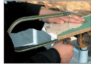
Fig. 1.24. Lucrul cu ferăstrăul de traforaj manual.
