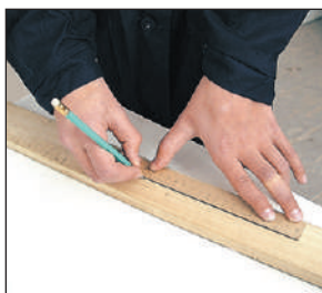
Fig. 1.16. Trăsarea unei linii cu rigla.
