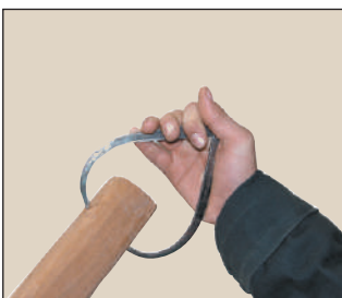
Fig. 1.19. Măsurarea dimensiunilor exterioare ale unei piese rotunde.
