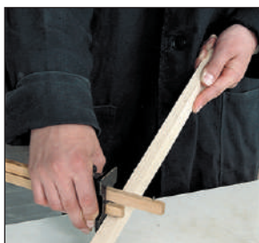
Fig. 1.18. Trăsarea liniilor paralele cu trasatorul paralel.
