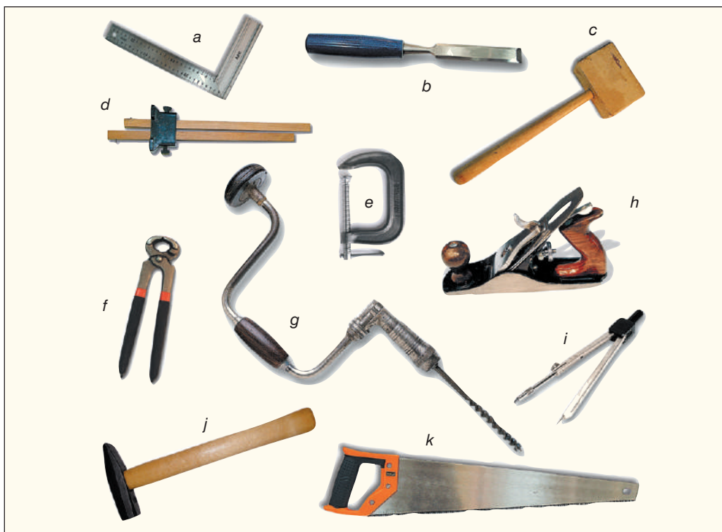
Fig. 1.11. Instrumente necesare la prelucrarea materialelor lemnoase: a – colțar; b – daltă de tâmplărie; c – ciocan de lemn; d – trasator paralel (ac de trasat sau zgârieți); e – menghină; f – clește de scos cuie; g – coarbă; h – rindea; j – ciocan; i – compas; k – ferăstrău.
