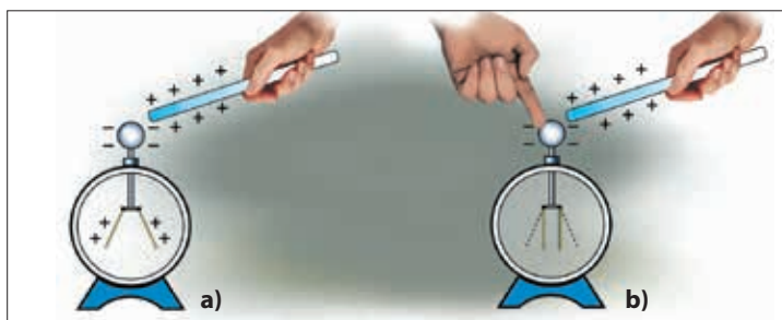
4.18. a) Încărcarea electroscopului prin influență; b) legarea cu Pământul
