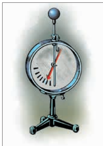
4.10. Electroscopul cu ac și cu cadran (electrometrul)
